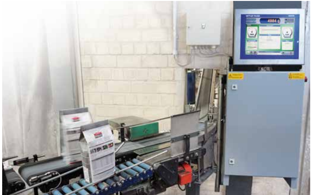
การชั่งน้ำหนักถุงแบบขาตั้งด้วยเครื่องตรวจสอบน้ำหนัก XS40
